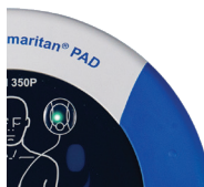
Figure 11. Voyant vert clignotant ; aucune action nécessaire.
